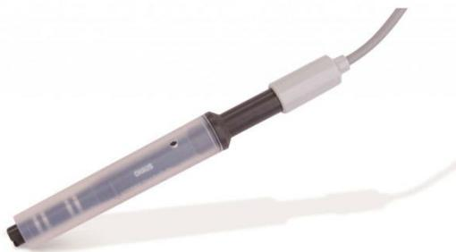
Рис. 2.10. Измерительный четырёхэлектродный датчик STCON3
