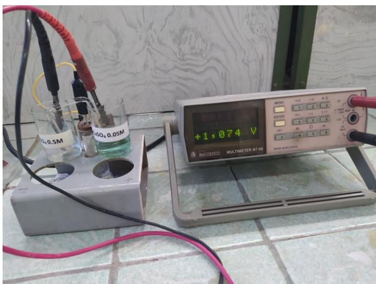
Рис. 5.4. Установка для измерения ЭДС и электродных потенциалов
