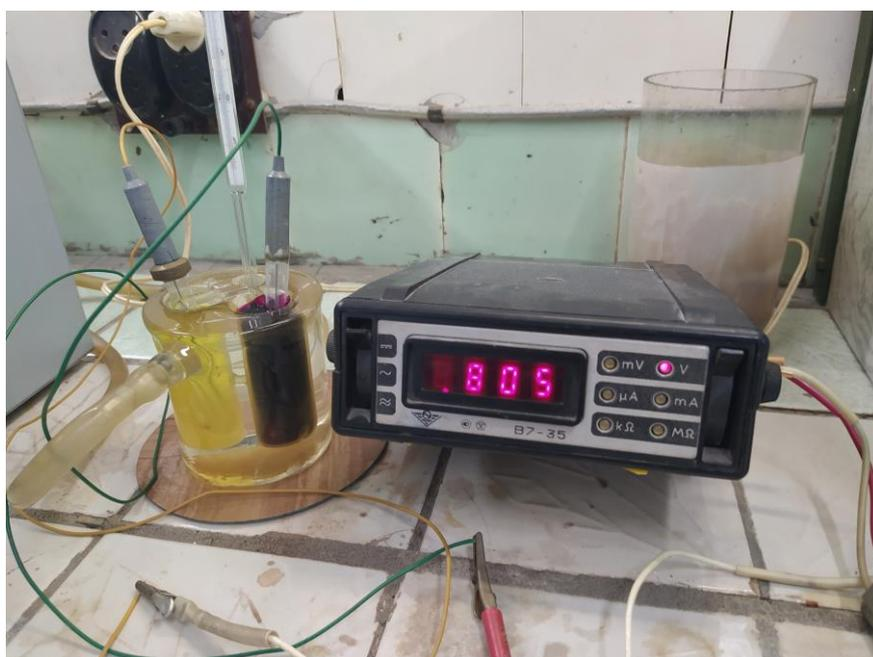
Рис. 5.10. Установка для измерения ЭДС элемента при различных температурах
