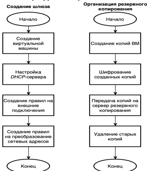
Рис. 4. Блок-схемы подпрограмм “Создание шлюза” и “Организация резервного копирования”
