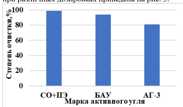
Рис. 2. Эффективность очистки сточной воды от нефтепродуктов активными углями при дозе 1 г/л
