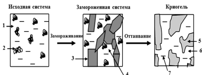
Рис. 1. Принципиальная схема криотропного гелеобразования: 1 – растворитель (вода); 2 – полимер-предшественник (ПВС); 3 – поликристаллы замёрзшего растворителя; 4 – незамёрзшая жидкая микрофаза (НЖМФ); 5 – полимерная сетка гелевой фазы гетерофазного криогеля; 6 – макропоры; 7 – растворитель (вода) [1].
