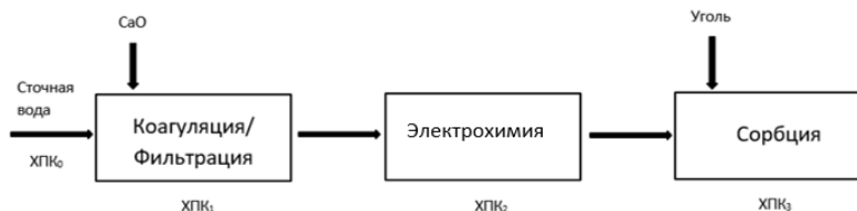
Рисунок 1. Блок-схема предложенной процедуры очистки сточных вод.
