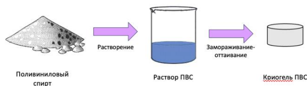
Рис.1. Схема получения криогелей поливинилового спирта.
