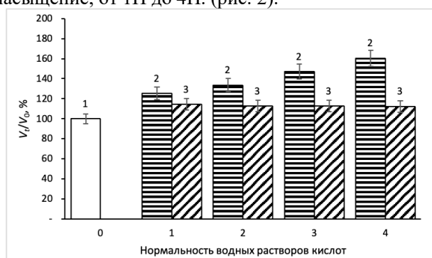
Рис. 2. Влияние различных концентраций растворов уксусной кислоты на зависимость объёма криогелей ПВС. (1 – КГПВС до помещения в уксусную кислоту, 2 – КГПВС после выдерживания в уксусной кислоте, 3 – КГПВС после отмывания в дистиллированной воде).
