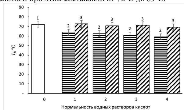
Рис. 4. Влияние различных концентраций растворов уксусной кислоты на зависимость температуры плавления криогелей ПВС. (1 – КГПВС до помещения в уксусную кислоту, 2 – КГПВС после выдерживания в уксусной кислоте, 3 – КГПВС после отмывания в дистиллированной воде).
