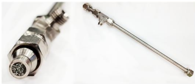
Рис. 1. Мембранный модуль для исследования газотранспортных характеристик полволоконных газораспределительных мембран.
