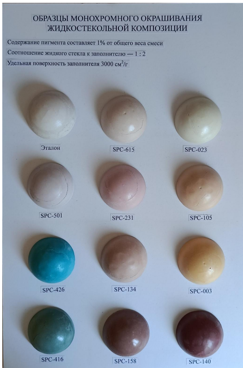
Рис.1. Образцы монохромного окрашивания жидкостекляной композиции. Содержание пигмента составляет 1% от общего веса смеси. Соотношение жидкого стекла к заполнителю — 1:2. Удельная поверхность заполнителя 3000см 2 /г. Образцы сверху вниз и слева на право: Эталон, SPC-615, SPC-023, SPC-501, SPC-231, SPC-105, SPC-426, SPC-134, SPC-003, SPC-416, SPC-158, SPC-140
