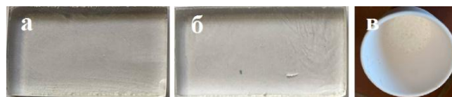
Рис. 2. Результат варки стёкол: а - состав ZBS 65-25-10; б- состав ZBS 55-35-10; в - состав ZBS 45-45-10
