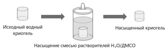
Рис. 2. Общая схема получения образцов КГПВС с различным составом растворителей.
