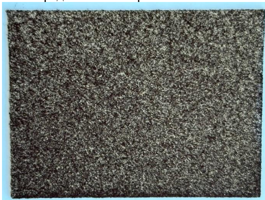
Рис. 1. Образец пластинки с растрескивающимся покрытием.
