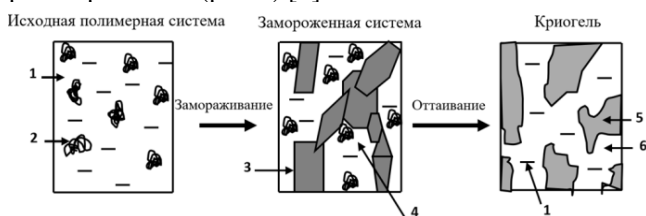
Рис. 1. Схема криотропного гелеобразования: 1 – растворитель; 2 – полимер-предшественник; 3 – поликристаллы замёрзшего растворителя; 4 – незамерзшая жидкая микрофаза; 5 – полимерная матрица криогеля; 6 – макропоры.
