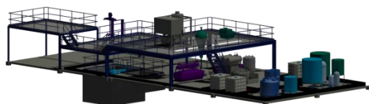
Рис.3. Линия утилизации медно-аммиачных отходов.
