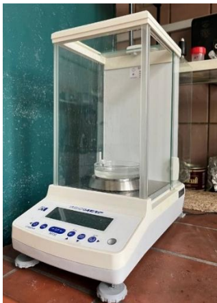
Рис.1. Аналитические весы с чашкой Петри для определения скорости потери массы
