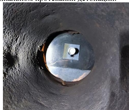
Рис. 2. Заряд ВВ, размещенный в мортревзрывной камеры
