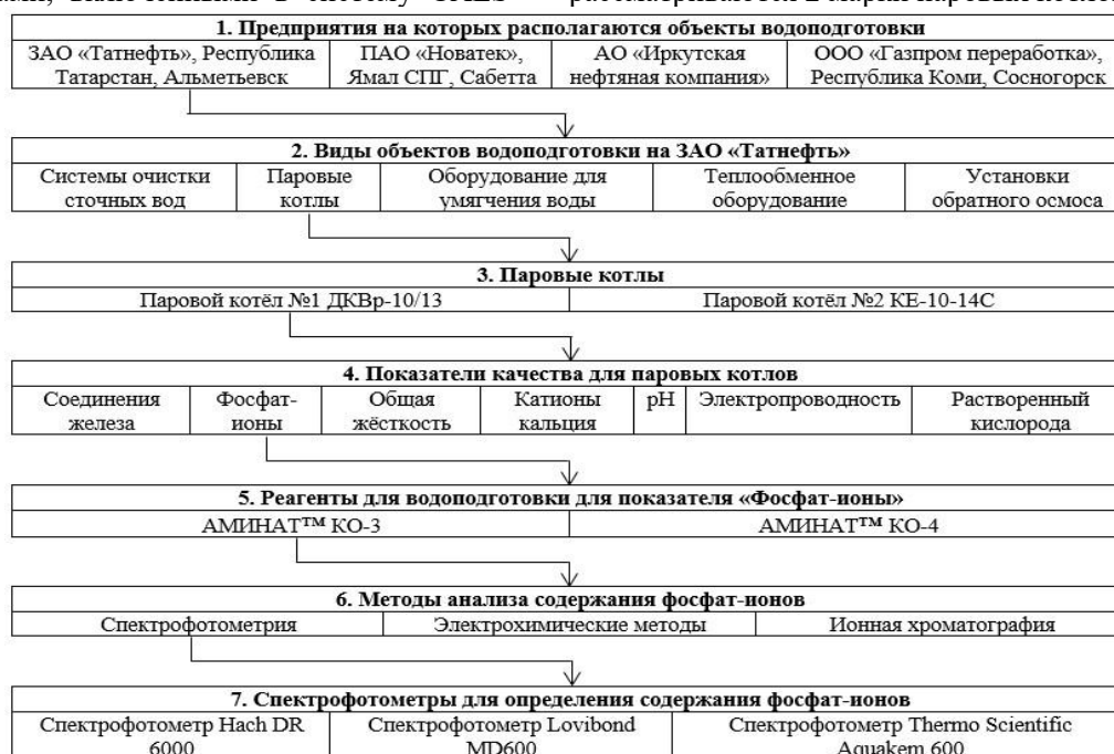
Рис. 3. Иерархическая структура промышленной водоподготовки: ЗАО «Татнефть» – Паровые котлы – Содержание фосфат-ионов– АМИНАТ™ КО-3 – Спектрофотометрия – Nach DR 6000
