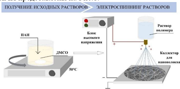
Рис.1. Основные стадии получения нановолокон на основе ПАН
